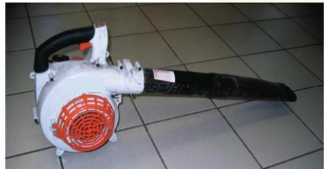
scoppio e da un tubo flessibile che serve per incanalare e orientare il flusso d'aria prodotto dalla ventola. L'attrezzatura, del peso di circa 10 kg, può essere portata a spalla tramite un'apposita imbracatura. L'operatore che utilizza la soffiante precede il mezzo di raccolta su strade e in giardini.
